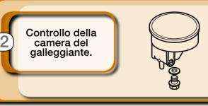
L'acqua all'interno della camera del galleggiante causa un guasto al motore. Rimuovere la camera del galleggiante e pulirla o sostituirla.
