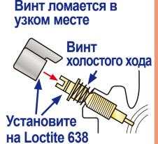
Установите и заверните новый винт холостого хода, выкрутите на необходимое количество оборотов. Ограничитель Затем установите колпачок с ограничителем на Loctite 638.
