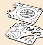
Membrane und Membranpumpe sind aus Gummi und können nach längerer Zeit verhärten, bzw. reißen.
