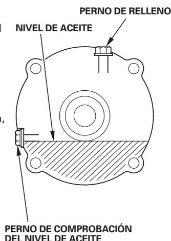
**Cambio del aceite****2 : 1 Caja de reducción con embrague centrífugo**
