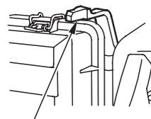
PALANCA DEL ESTRANGULADOR (filtro de aire del tipo sencillo)
