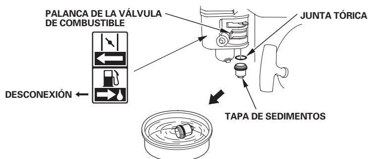
3. Ponga la junta tórica en la válvula de combustible, e instale la taza de sedimentos. Apriete con seguridad la taza de sedimentos.
