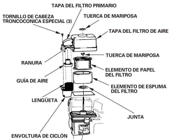
5. Limpie los elementos del filtro de aire si debe volver a utilizarlos.
