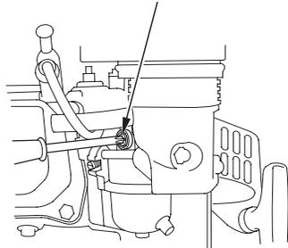
Velocidad de ralentí estándar:  $1.400 \pm_{150}^{+200} \text{ min}^{-1} \text{ (rpm)}$
