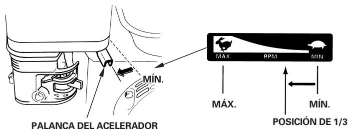
Algunas aplicaciones del motor emplean un control del acelerador montado a distancia en lugar de la palanca del acelerador montada en el motor aquí mostrada. Consulte las instrucciones suministradas por el fabricante del equipo.
