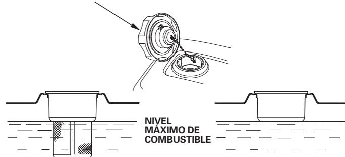
Reposte con cuidado para que no se derrame combustible. No llene por completo el depósito de combustible. Es posible que sea necesario reducir el nivel del combustible dependiendo de las condiciones de operación. Después de repostar, vuelva a enroscar la tapa de relleno de combustible hasta que produzca un sonido seco de confirmación.
