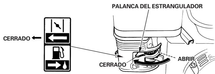
Para arrancar el motor cuando está caliente, deje la palanca del estrangulador en la posición OPEN.
