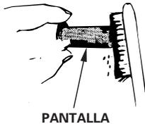
2. Instale el parachispas, el protector del silenciador, y el deflector de escape en el orden inverso al de la extracción.
