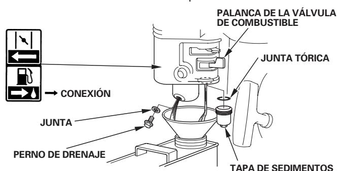
3. Después de haber drenado todo el combustible en el recipiente, vuelva a instalar el perno de drenaje, la empaquetadura, la taza de sedimentos y la junta tórica. Apriete con seguridad el perno de drenaje y la taza de sedimentos.
