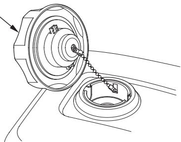
2. Aggiungere carburante fino al bordo inferiore del limite di livello massimo del carburante del serbatoio. Non riempire eccessivamente. Asciugare il carburante eventualmente fuoriuscito prima di avviare il motore.
