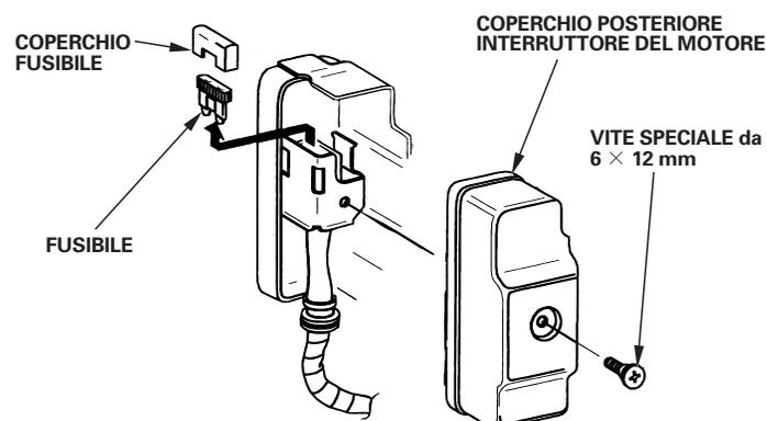
Un guasto frequente al fusibile indica l'esistenza di un cortocircuito o un sovraccarico nell'impianto elettrico. Se il fusibile si brucia troppo spesso, portare il motore da un concessionario Honda per le riparazioni del caso.
