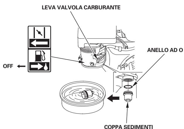
3. Collocare l'anello ad O sul rubinetto del carburante e installare il pozzetto del filtro. Serrare saldamente il pozzetto del filtro.
