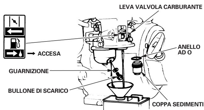
4. Dopo aver scaricato il carburante nel recipiente, rimontare il bullone di scarico, la guarnizione, il pozzetto del filtro e l'anello ad O. Serrare a fondo il bullone di scarico e il pozzetto del filtro.
