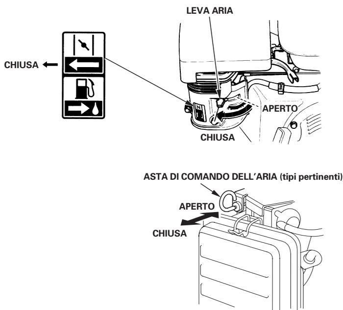
Per riavviare un motore caldo, lasciare la leva o l'asta di comando dell'aria sulla posizione CHIUSA.
