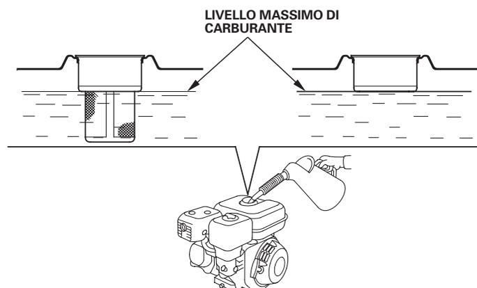
3. Rifornire con precauzione per evitare fuoriuscite di carburante. Non riempire completamente il serbatoio del carburante. A seconda delle condizioni d'uso, potrebbe essere necessario abbassare il livello del carburante. Dopo il rifornimento, serrare saldamente il tappo di rifornimento del carburante.
