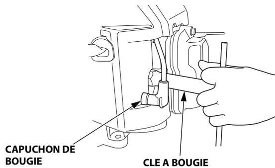
3. Contrôler les bougies. Les remplacer si elles sont endommagées, très encrassées, si leur rondelle d'étanchéité est en mauvais état ou si leur électrode est usée.
