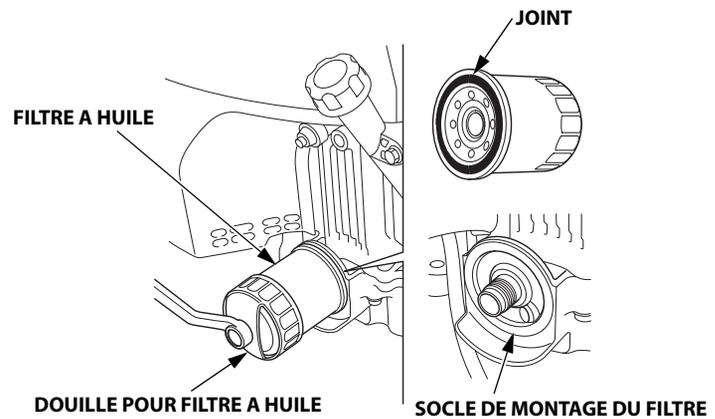
3. Nettoyer le socle de montage du filtre et enduire le joint d'un filtre à huile neuf avec de l'huile moteur propre.
