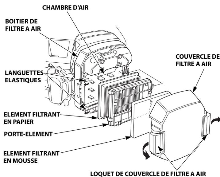
4. Contrôler les deux éléments filtrants et les remplacer s'ils sont endommagés. Toujours remplacer l'élément filtrant en papier aux intervalles prévus dans le programme d'entretien (voir page 6).
