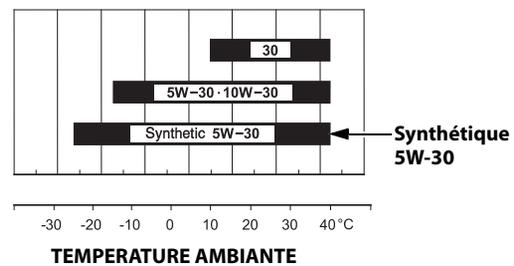
Une huile SAE 10W-30 ou 5W-30 est recommandée pour un usage général. Pour des températures de démarrage/fonctionnement comprises entre -15 et -25 °C, utiliser une huile 5W-30 entièrement synthétique. Les autres viscosités indiquées dans le tableau peuvent être utilisées lorsque la température moyenne du lieu d'utilisation se trouve dans la plage indiquée.
