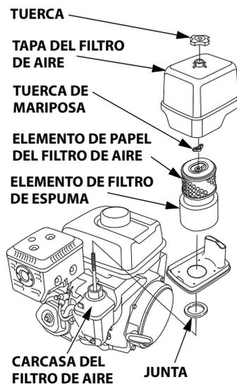
Elemento de papel del filtro: Golpee varias veces el elemento del filtro contra una superficie dura para sacar la suciedad, o sople aire comprimido [sin exceder 207 kPa, (2,1 kgf/cm<sup>2</sup>)] por el elemento del filtro desde el interior. No trate nunca de cepillar la suciedad; el cepillo forzaría la suciedad al interior de las fibras.
