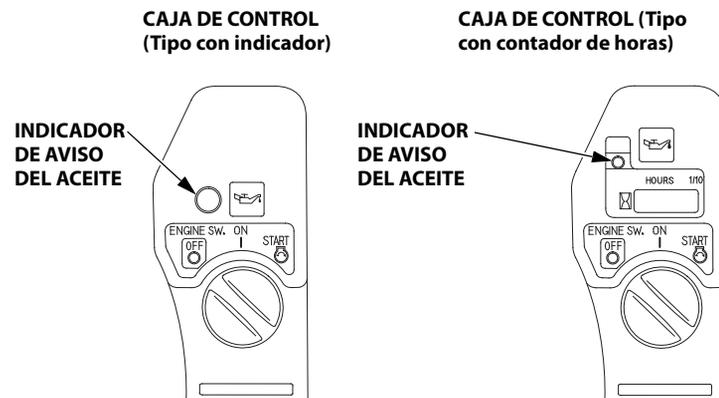
Para realizar la comprobación del indicador de aviso de aceite, el motor debe conectarse a una batería y el interruptor del motor debe estar en la posición ON.
